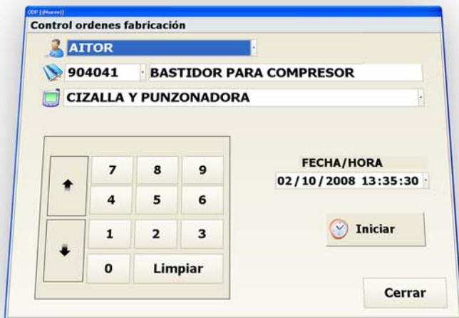
Con ODF TAC mediante su pantalla táctil, podemos controlar los órdenes de fabricación que actualmente tenemos activas y los empleados que tenemos trabajando en las mismas.
